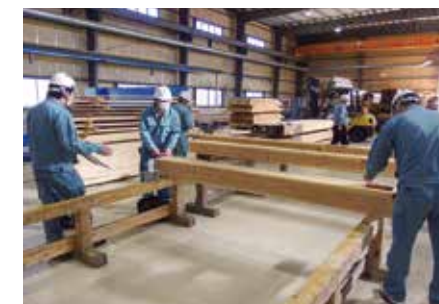
プレカット工場 木材の検査の徹底(品質管理)
